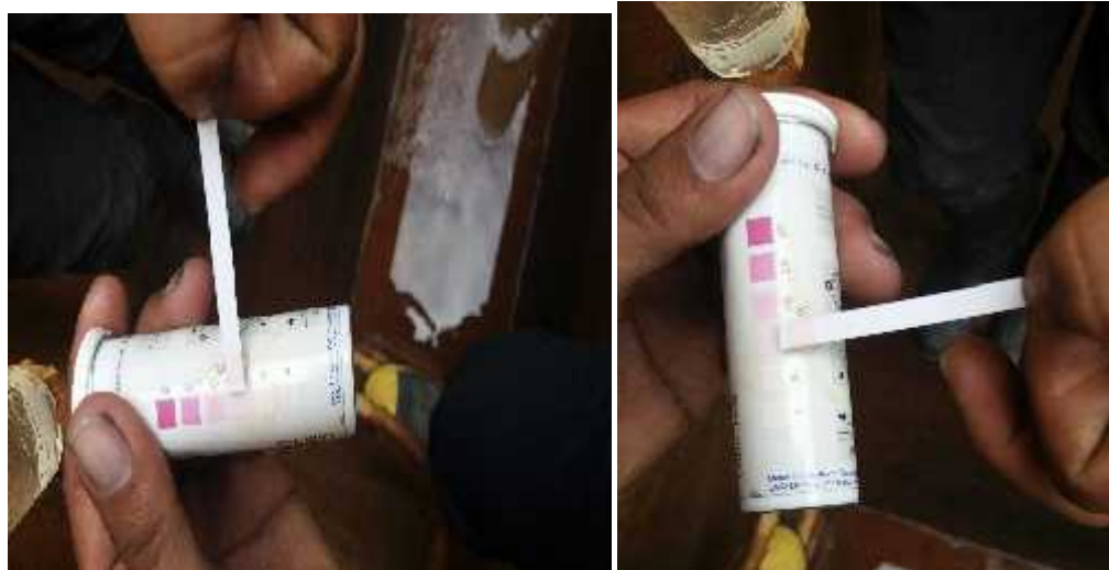
Desinfección en 50 ppm material existente filtro N° 1
