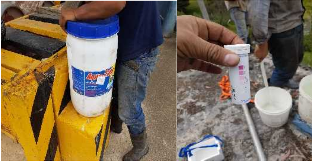
Hipoclorito de calcio al 67 % y mezcla en agua.
