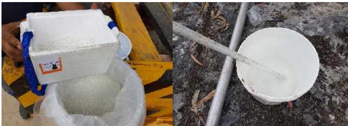
Hipoclorito de calcio al 67 % y mezcla en agua.
