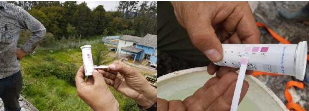
Comprobación medición agua clorada en 50 ppm para desinfección.
