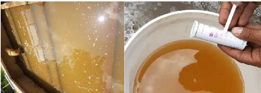
Medición y confirmación de las 50 ppm de cloro en el lecho filtrante.
