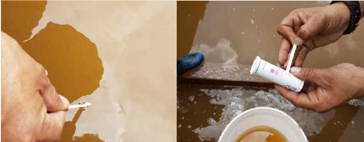
Medición y confirmación de las 50 ppm de cloro en el lecho filtrante.
