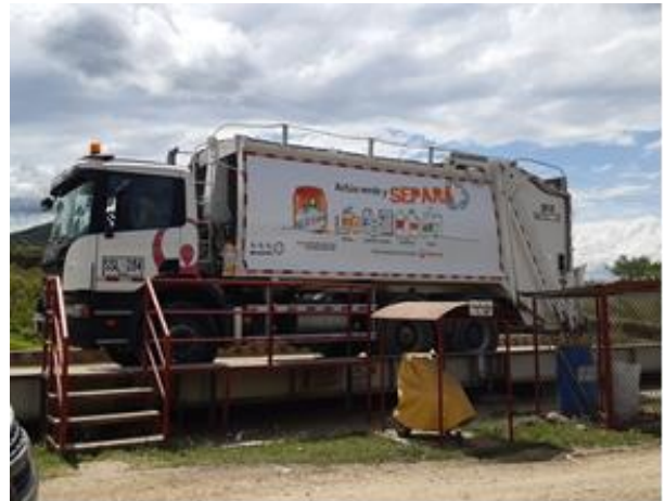
Foto 8. Báscula camionera al momento del pesaje de vehículo recolector
