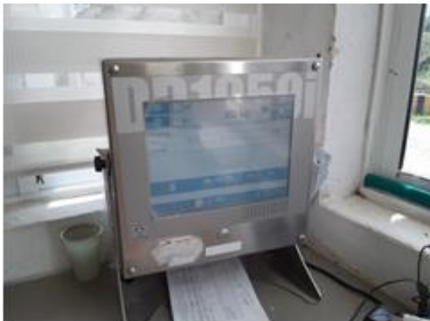
Foto 5. Instrumentación electrónica propia de la báscula camionera
