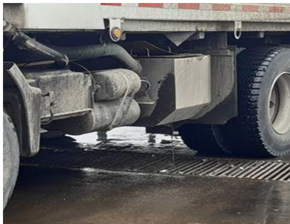
Foto 10. Detalle descargue de lixiviados
