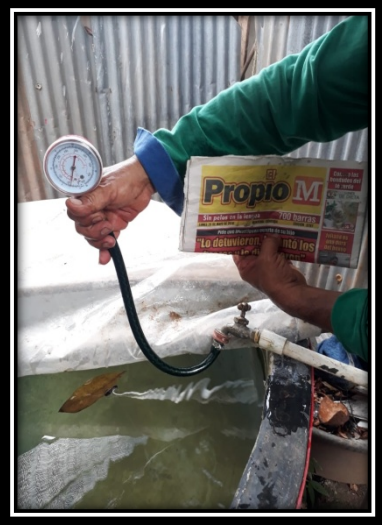
Fotos 45, 46 y 47. Evidencias fotográfica de medición de presión en conexión intradomiciliaria
