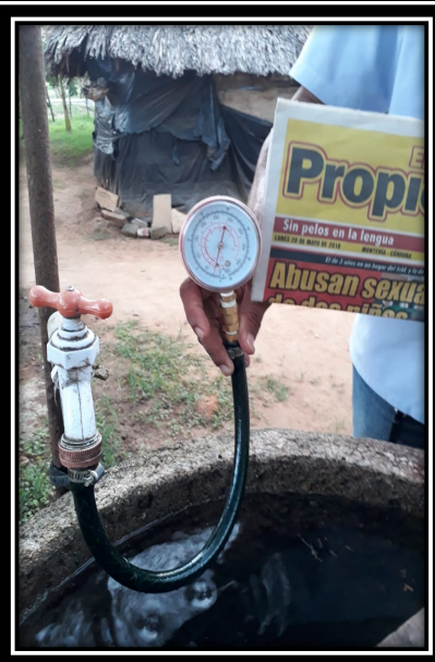
Fotos 60, 61 y 62. Evidencias fotográfica de medición de presión en conexión intradomiciliaria.
