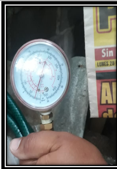
Fotos 48, 49 y 50. Evidencias fotográfica de medición de presión en conexión intradomiciliaria
