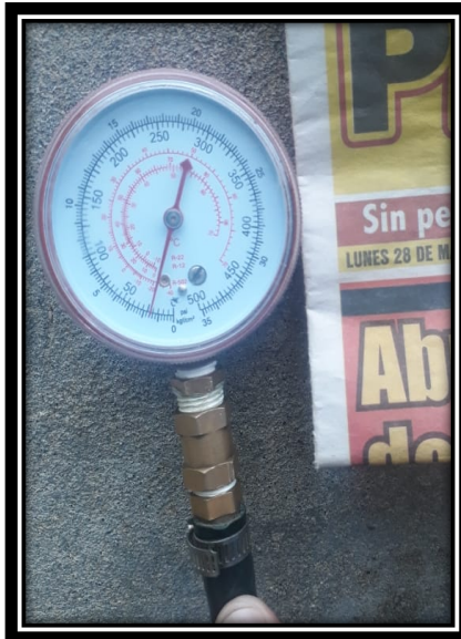
Fotos 57, 58 y 59. Evidencias fotográfica de medición de presión en conexión intradomiciliaria
