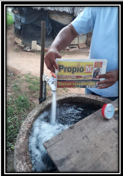
Fotos 60, 61 y 62. Evidencias fotográfica de medición de presión en conexión intradomiciliaria.
