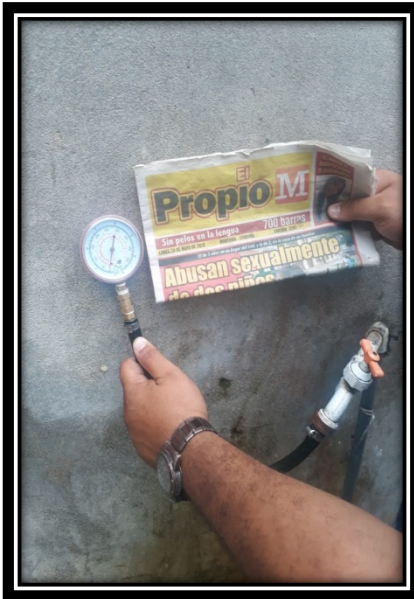
Fotos 57, 58 y 59. Evidencias fotográfica de medición de presión en conexión intradomiciliaria
