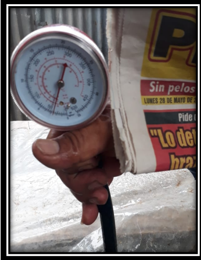
Fotos 45, 46 y 47. Evidencias fotográfica de medición de presión en conexión intradomiciliaria
