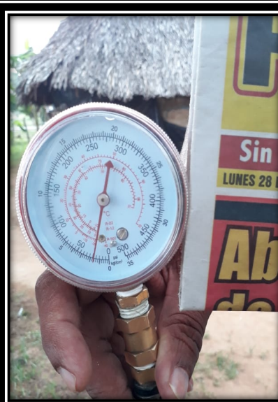
Fotos 60, 61 y 62. Evidencias fotográfica de medición de presión en conexión intradomiciliaria.
