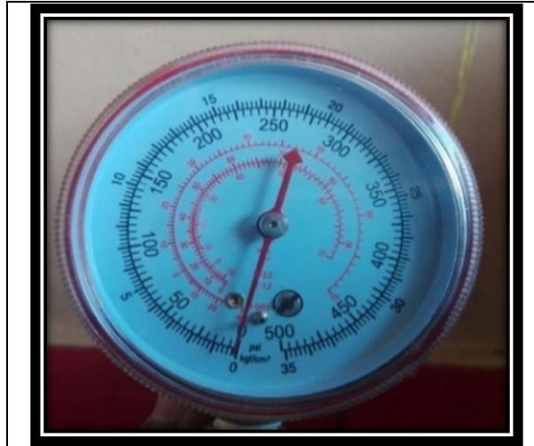
Foto 33. Manómetro empleado para la realización de toma de muestras.
