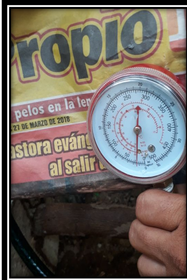
Fotos 37, 38 y 39. Evidencias fotográfica de medición de presión en conexión intradomiciliaria
