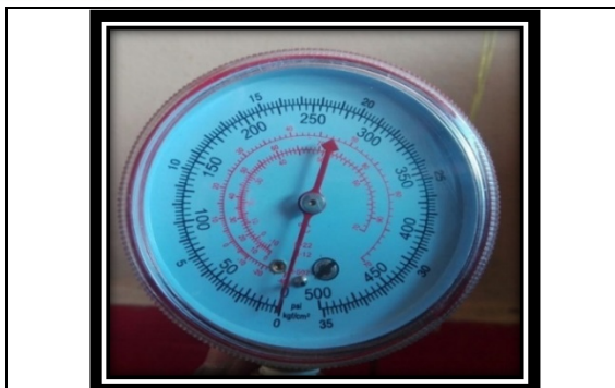
Foto 30. Manómetro empleado para la realización de toma de muestras.
