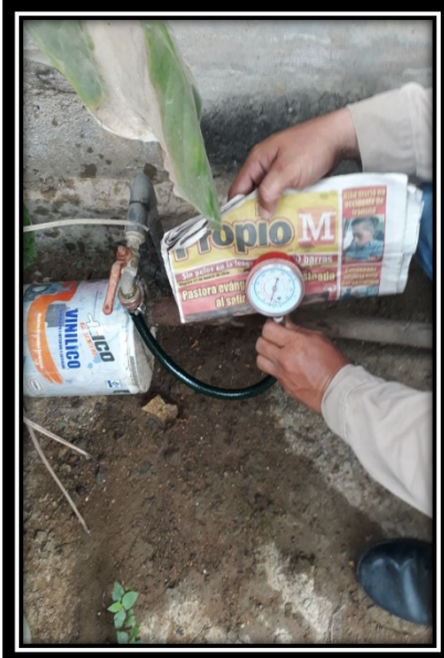
Fotos 37, 38 y 39. Evidencias fotográfica de medición de presión en conexión intradomiciliaria
