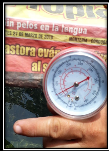
Fotos 34, 35 y 36. Evidencias fotográfica de medición de presión en conexión intradomiciliaria
