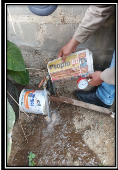
Fotos 37, 38 y 39. Evidencias fotográfica de medición de presión en conexión intradomiciliaria
