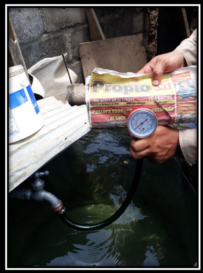
Fotos 34, 35 y 36. Evidencias fotográfica de medición de presión en conexión intradomiciliaria
