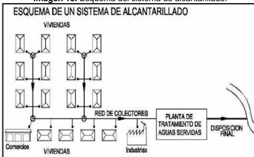
Imagen 18. Esquema del sistema de alcantarillado.
