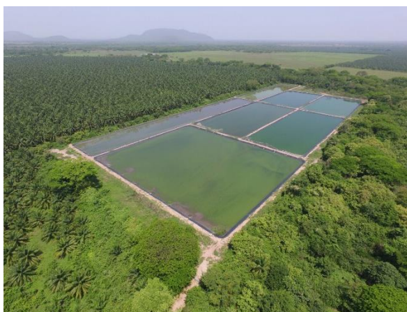
Imagen 19. Lagunas de oxidación
