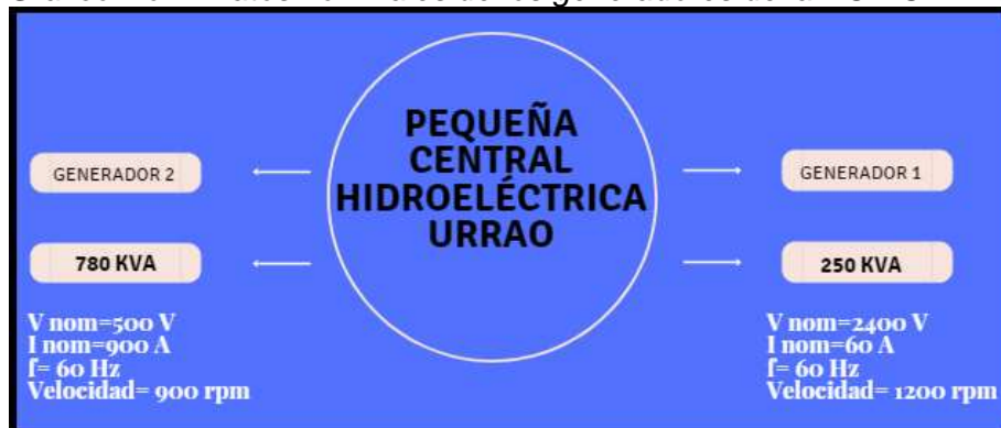
Gráfico No 4. Datos nominales de los generadores de la PCH URRAO
