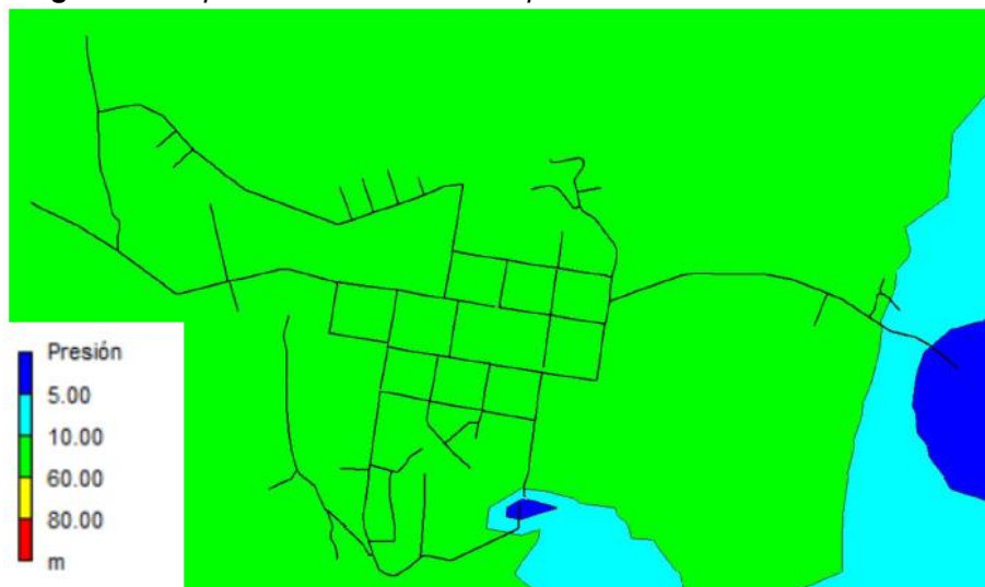
Imagen 19. Esquema de distribución de presiones – escenario Qmax a 2042.
