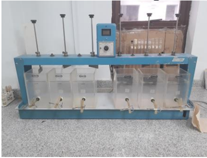
Equipo Ensayo de Jarras
