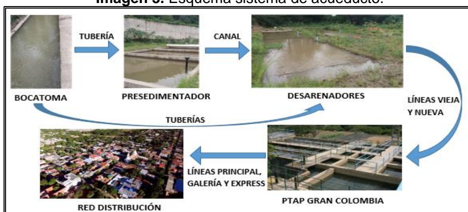
Imagen 3. Esquema sistema de acueducto.
