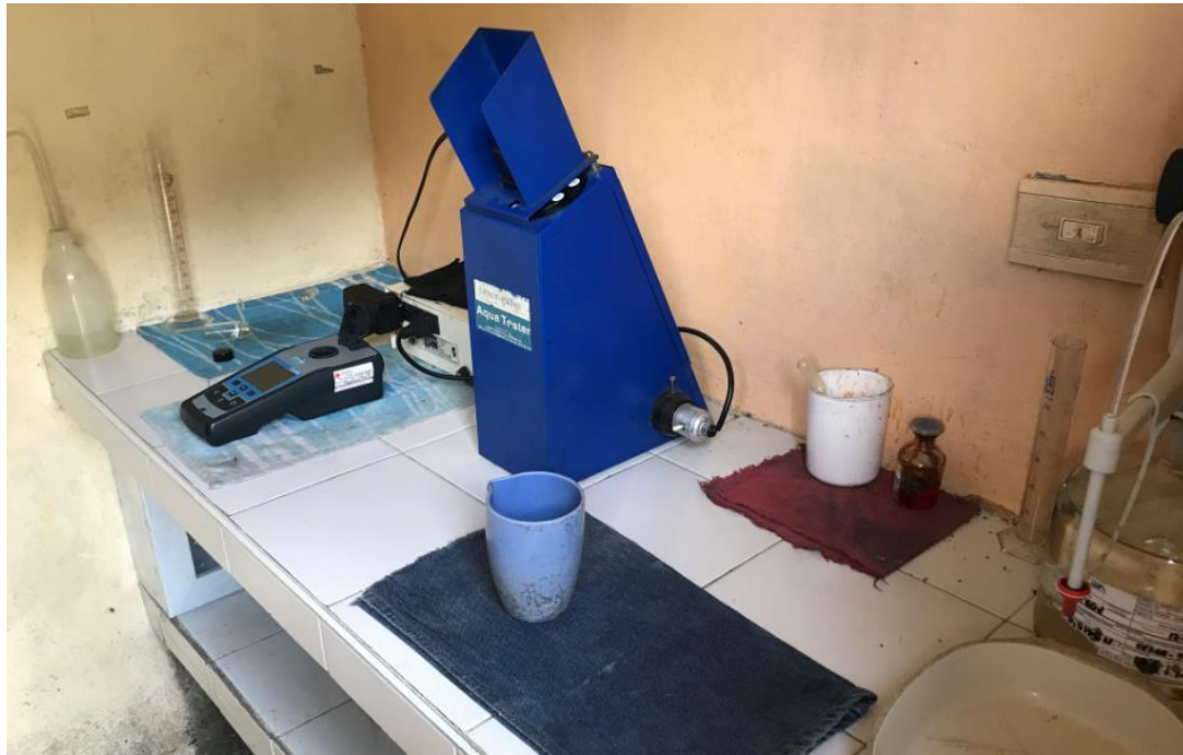
Instrumentos de medición de parámetros de la calidad del agua cruda
