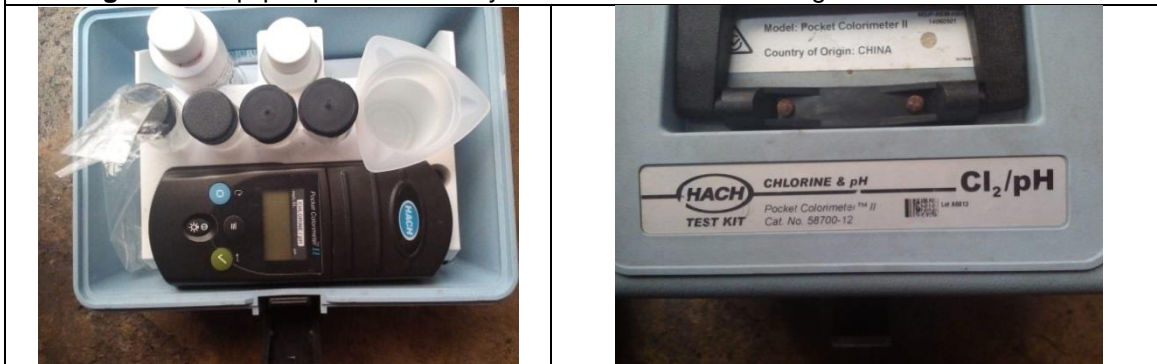
Imagen 23. Equipos para medición y control de la calidad del agua en red de distribución
