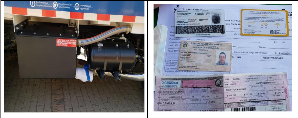
Imagen 90. Caja de lixiviados
