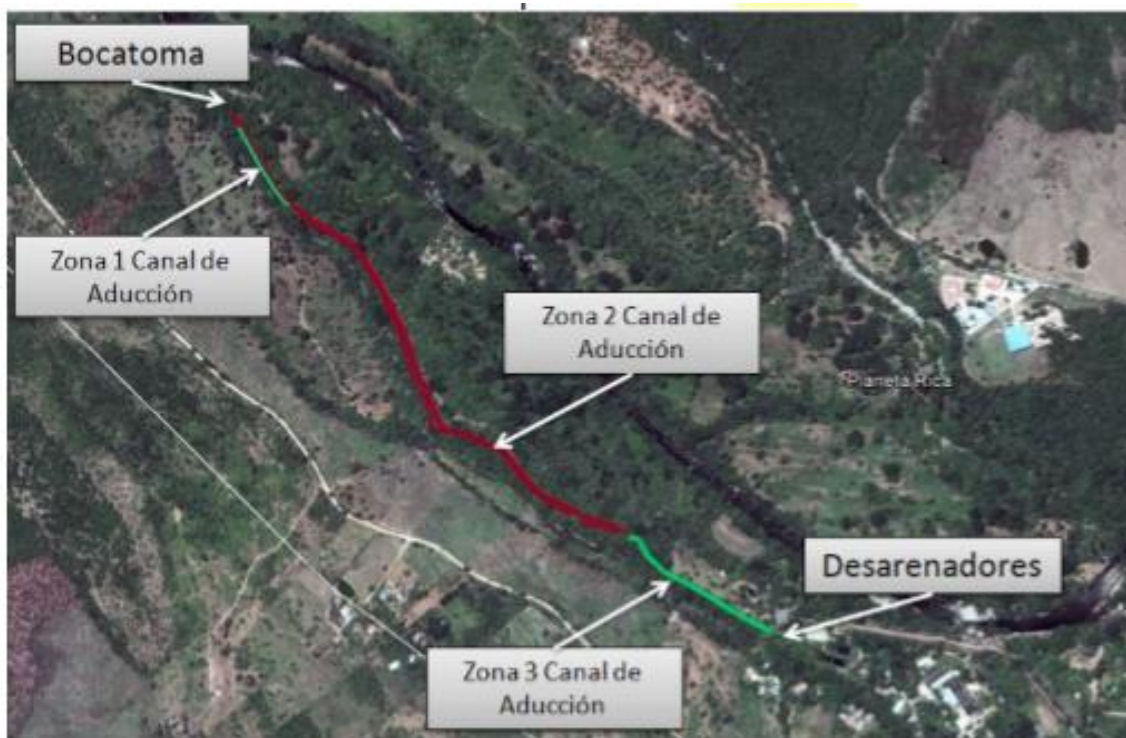
Figura 10. Esquema de Trazado del Canal de Aducción – EMDUPAR S.A E.S.P
