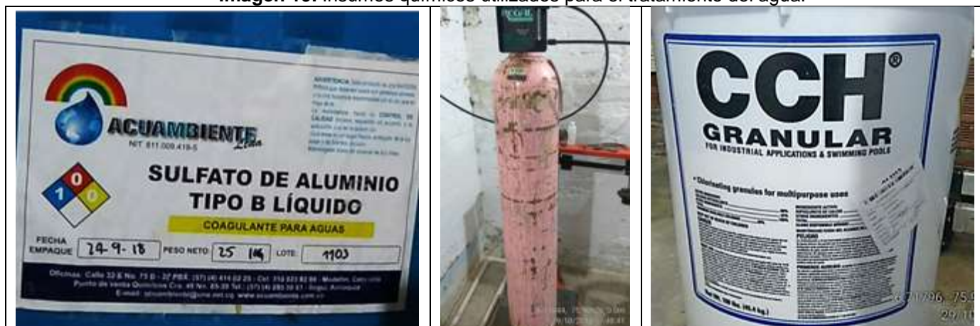
Imagen 19. Insumos químicos utilizados para el tratamiento del agua.
