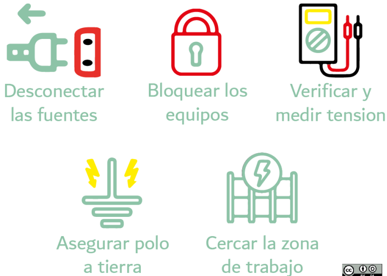
Ilustración 2. Las 5 reglas de oro de la electricidad
