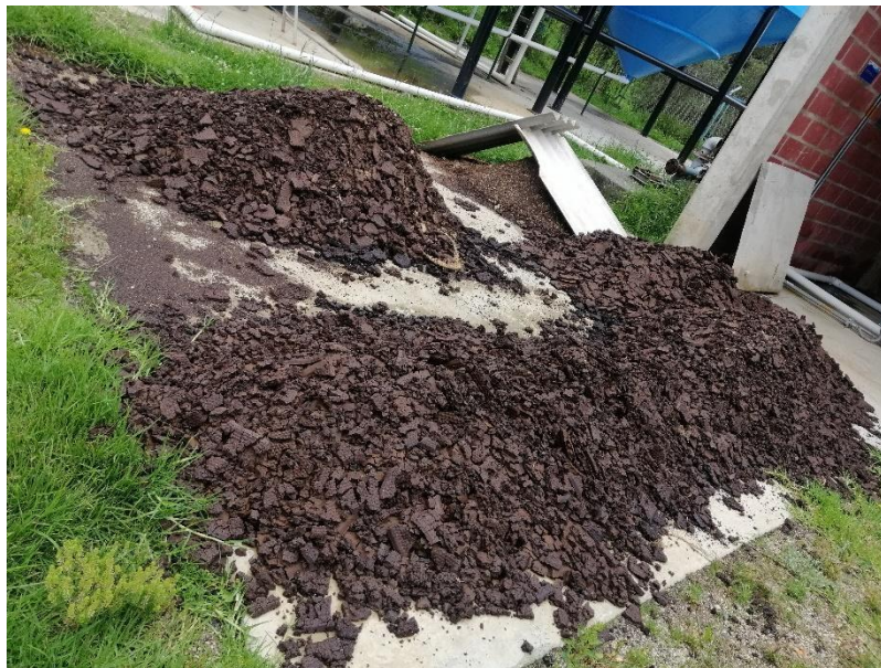
Imagen 48. Lodos generados en el proceso de potabilización de la PTAP Terebinto
