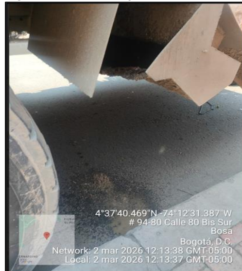
Figura 17. Presunta perdida de lixiviado
