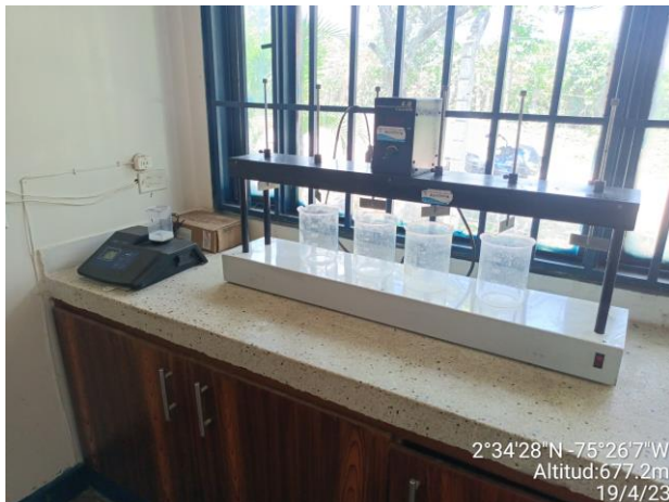
Imagen 15. Equipo de jarras, photo flex, báscula electrónica.
