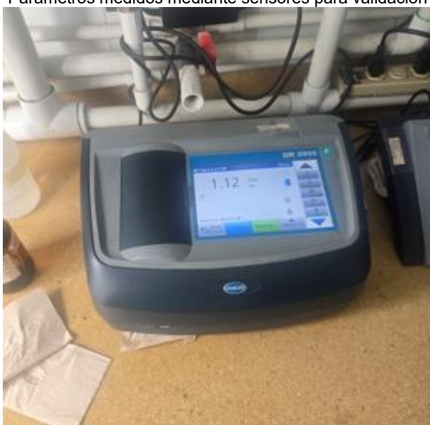
Medidor de cloro
