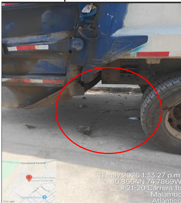
Foto 17. Pérdida de líquido (lixiviados) vehículo placa SDU 347
