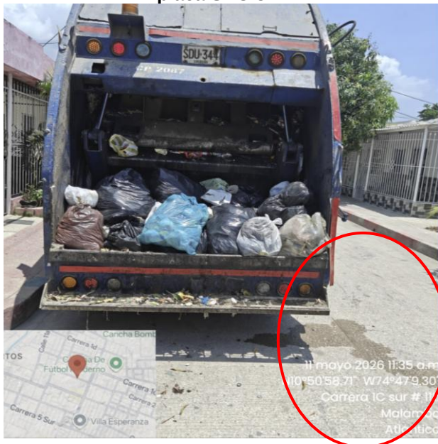
Foto 17. Pérdida de líquido (lixiviados) vehículo placa SDU 347
