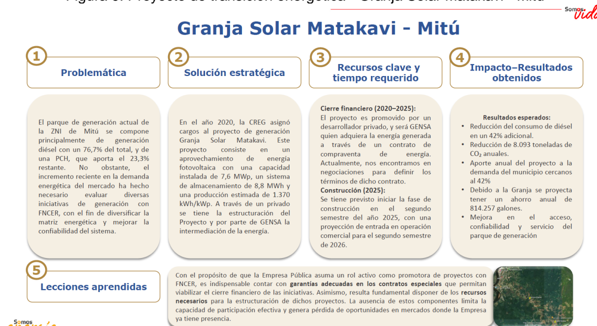
Figura 9. Proyecto de transición energética - Granja Solar Matakavi - Mitú
