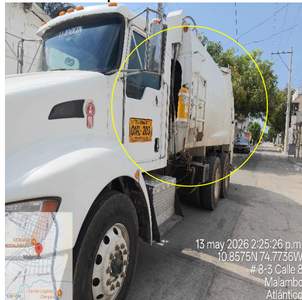
Foto 12. Caja de compactación. Vehículo con placa OML 203.
