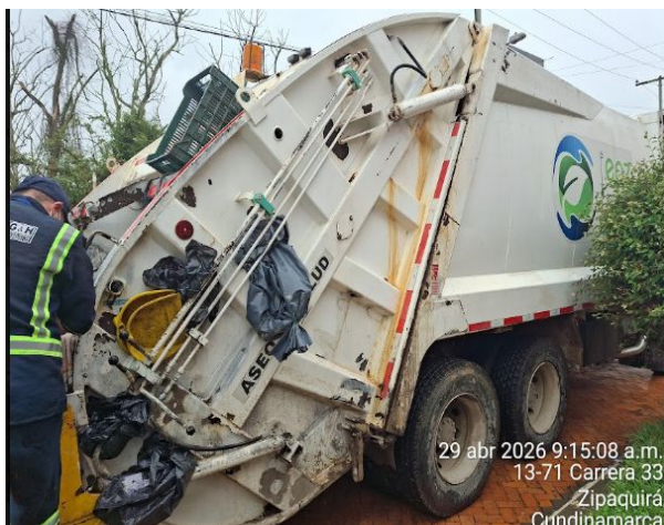
Foto 35 Control del sistema de compactación mediante palancas. Vehículo OLM 705
