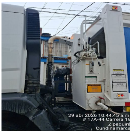
Foto 35 Control del sistema de compactación mediante palancas. Vehículo OLM 705
