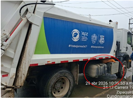
Foto 39 Estribos antideslizantes y manijas de sujeción. Vehículo GRU 182
