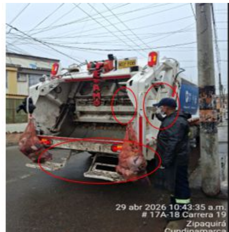
Foto 42 Estribos antideslizantes y manijas de sujeción. Vehículo NSY908
