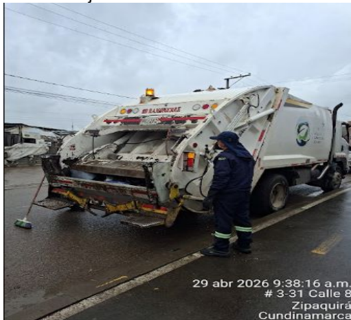
Foto 39 Estribos antideslizantes y manijas de sujeción. Vehículo GRU 182
