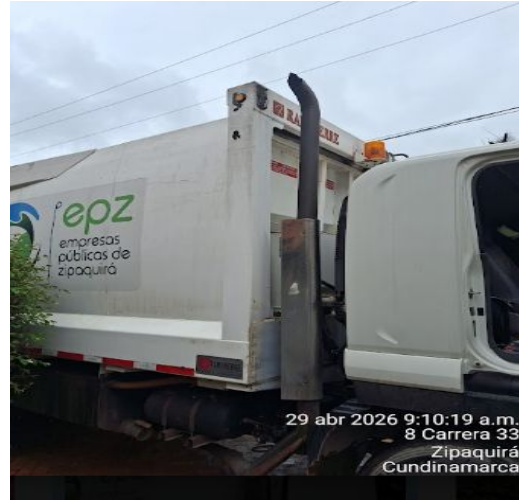
Foto 34 Tubo de escape por encima de la cabina. Vehículo GRU182
