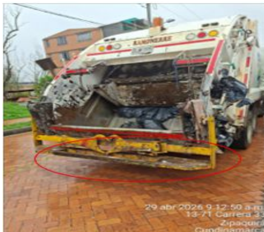
Foto 41 Estribos antideslizantes y manijas de sujeción. Vehículo OLM705
