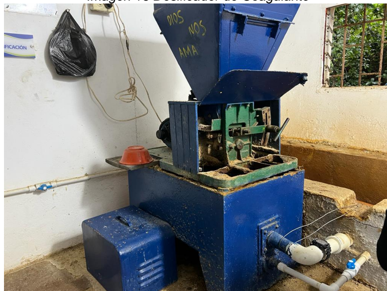
Imagen 16 Dosificador de Coagulante
