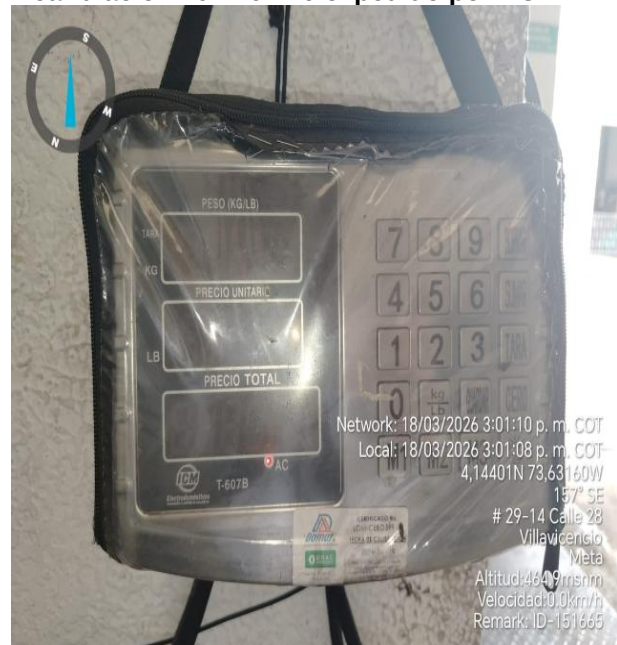
Foto 17. Báscula de pesaje con datos de certificado No. LDM-CEBD 599, fecha de calibración 2024-04-19 expedido por DOMAT
