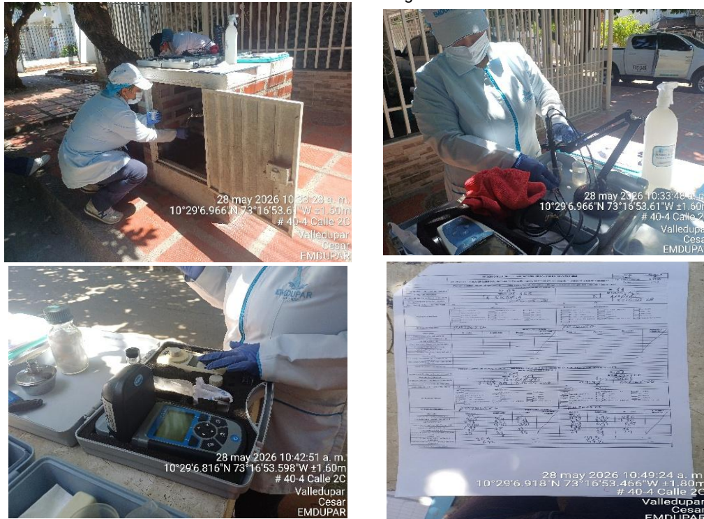
Imagen 19. Toma de muestras y análisis fisicoquímico insitu por parte de la persona prestadora en el punto de muestreo N° 24 El Refugio
