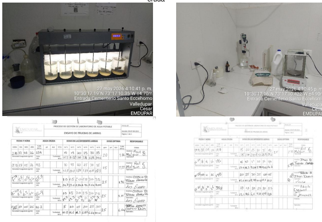
Imagen 11. Test de jarras, equipos y elementos del cuarto de operaciones y registro de caracterización de agua cruda
