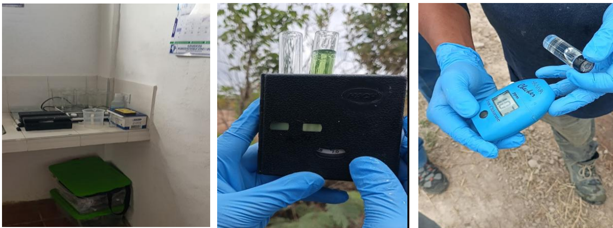
Imagen 24. Laboratorio y equipos portátil para análisis de cloro residual y pH en agua potable
