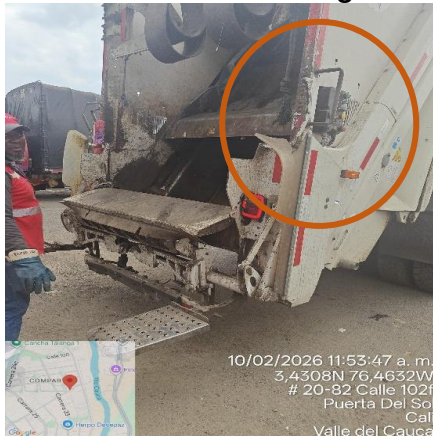
Foto 32. Mecanismo para detener la compactación en caso de emergencia ETL186
