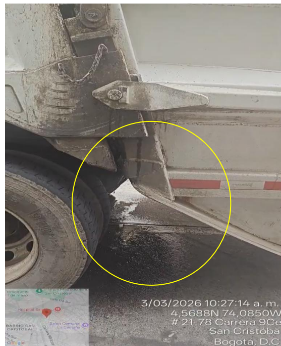
Foto 25. Derrame de lixiviados del vehículo con placa NWX533
