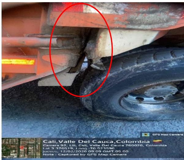
Foto 20. Pérdida de líquido (lixiviados) vehículo placa WFM430
