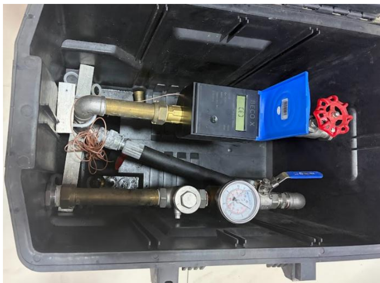
Imagen 24. Banco portátil de pruebas de caudal
