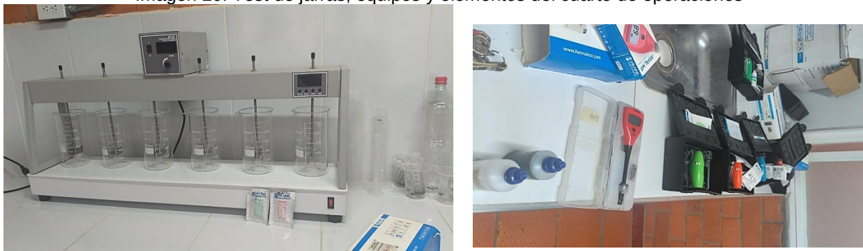
Imagen 20. Test de jarras, equipos y elementos del cuarto de operaciones
