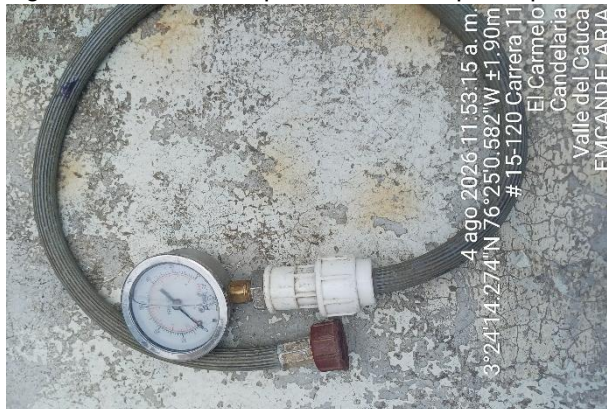
Imagen 29. Manómetro portátil utilizado por el prestador
