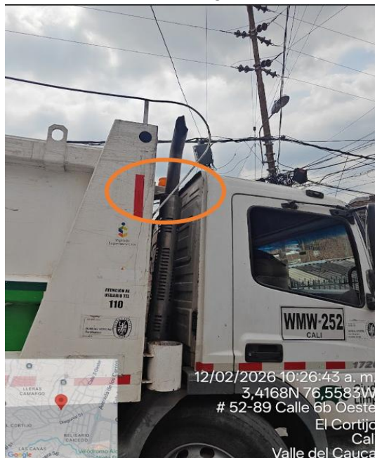
Foto 59. Luces encima de la cabina tipo estroboscópico vehículo con placa WMW252
