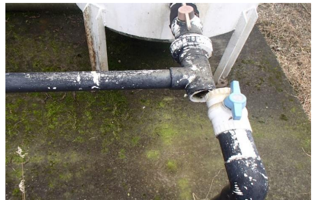
Imagen 38. Fracturación de conexión hidráulica
