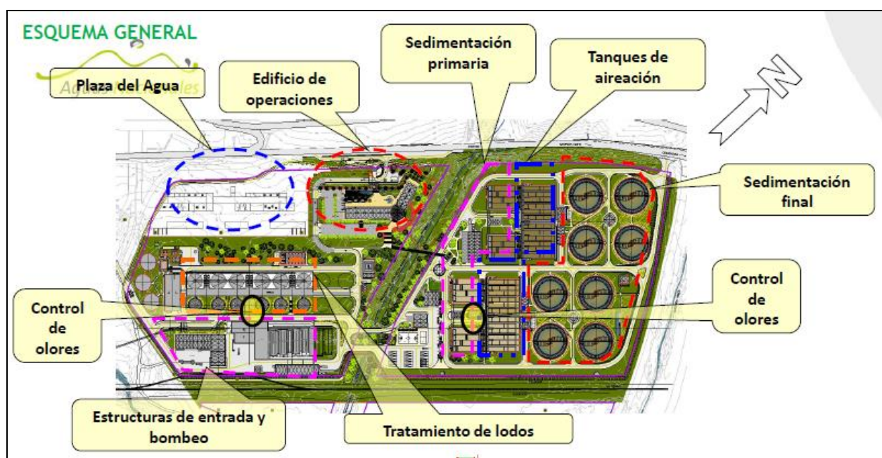
Figura 4-4 Esquema general de la PTAR Bello.
