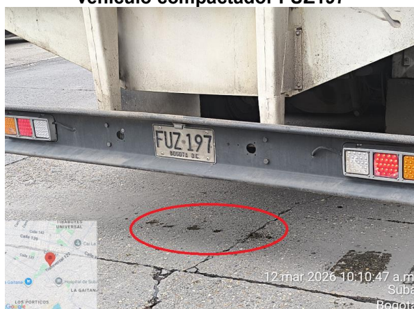
Foto 69. Goteo de líquido lixiviado del vehículo compactador FUZ197
