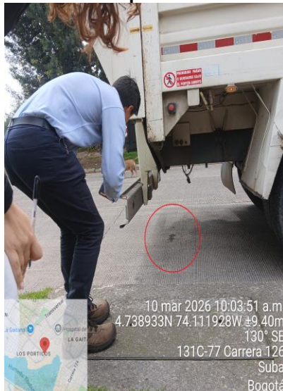
Foto 65. Goteo de líquido lixiviado del vehículo compactador FUZ198
