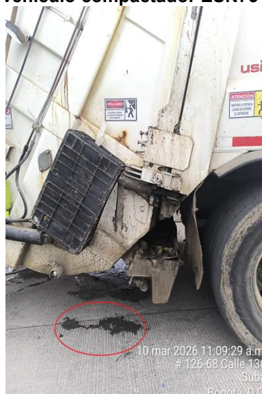
Foto 69. Goteo de líquido lixiviado del vehículo compactador FUZ197
