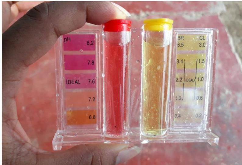
En esta imágenes podemos apreciar que la medición del cloro residual esta en 1.2 mg/L.
