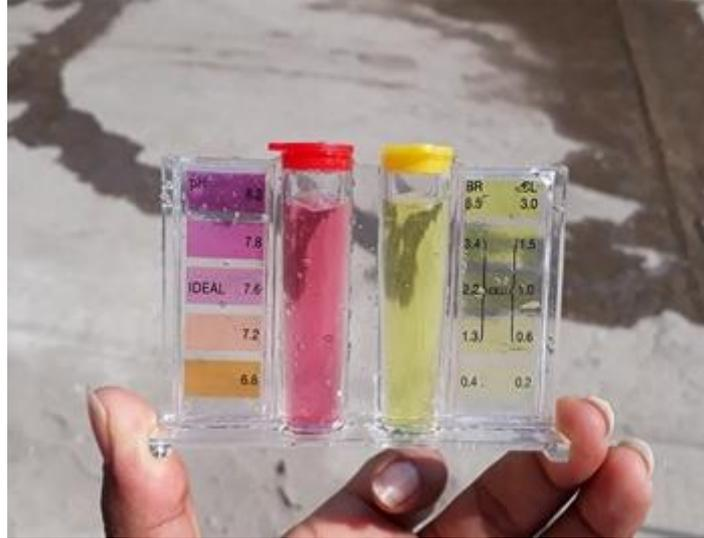
En esta imágenes podemos apreciar que la medición del cloro residual esta en 0.8 mg/L.
