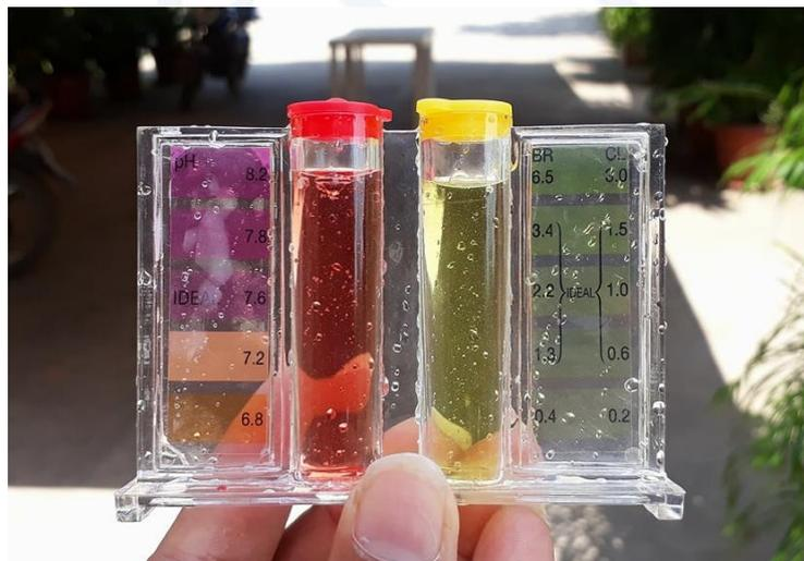
En esta imágenes podemos apreciar que la medición del cloro residual esta en 1.2 mg/L.
