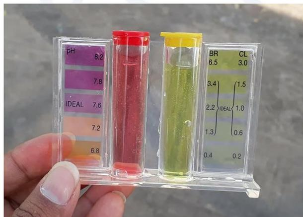
En esta imágenes podemos apreciar que la medición del cloro residual esta en 1.2 mg/L. el cual está dentro de los parámetros.
