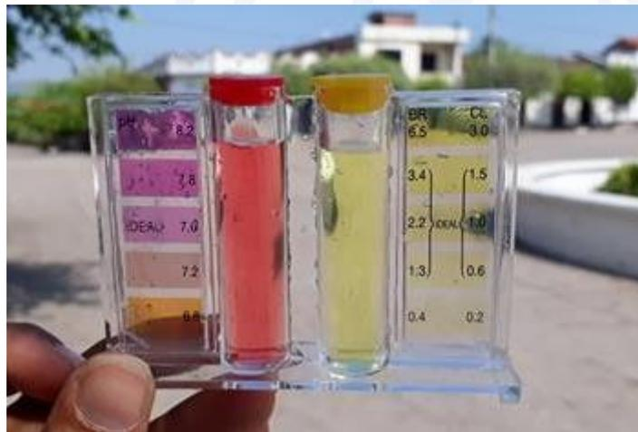
En esta imágenes podemos apreciar que la medición del cloro residual esta en 0.6 mg/L.
