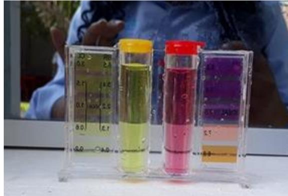
En esta imágenes podemos apreciar que la medición del cloro residual esta en 1.4 mg/L.
