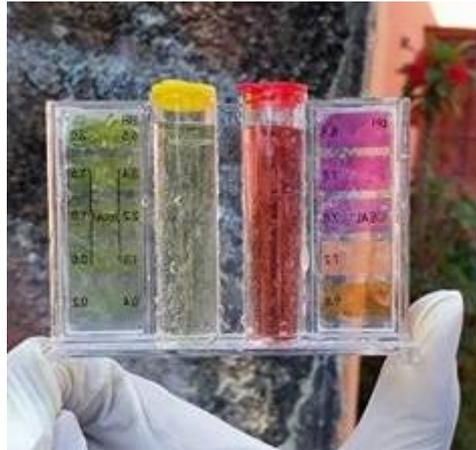
En esta imágenes podemos apreciar que la medición del cloro residual esta en 0.4 mg/L. el cual está dentro de los parámetros.
