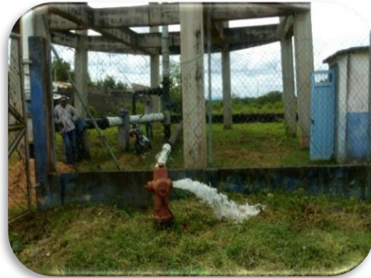
Pruebas de llenado Tanque Zona 1 con 40 l/s
