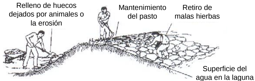
Esquema Mantenimiento de las instalaciones
