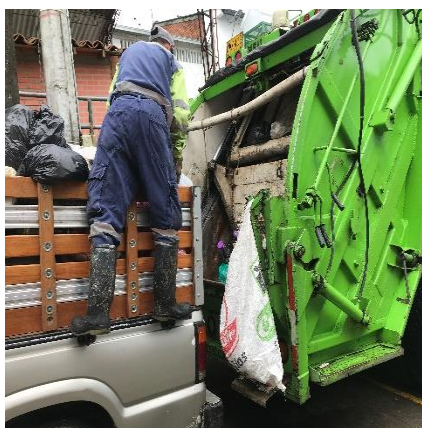
Paso de residuos del vehículo de estacas al compactador
