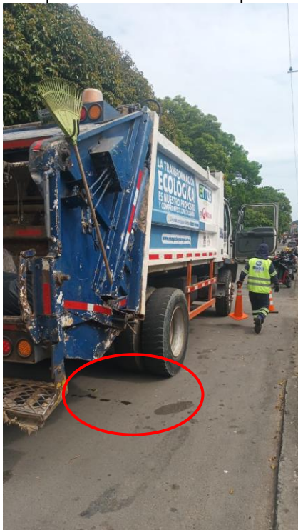
Foto 14. Elementos para dispersión de residuos y pérdida de líquido lixiviado vehículo placa AUU 462
