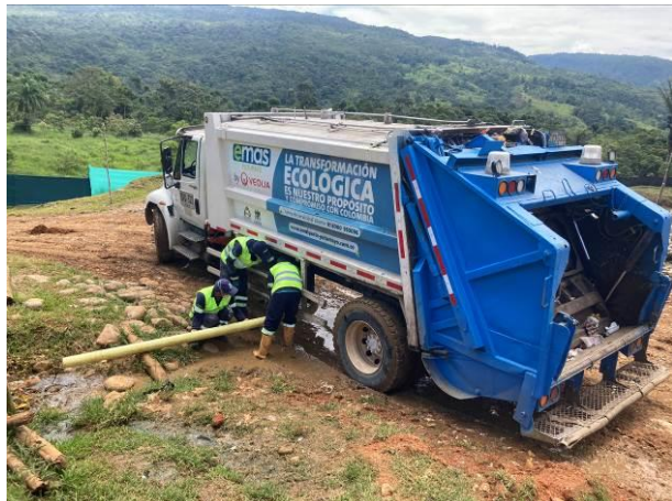
Foto 71. Descarga de líquido lixiviado de los vehículos
