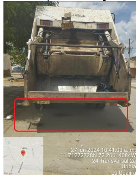
Foto 22. Vehículo placa OZJ911. Fuga de lixiviados
