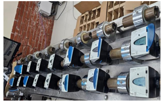
Calibración de medidores con telemetría
