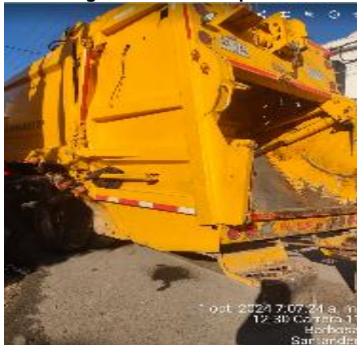
Foto 7. Fuga lixiviados compactador SXJ 762
