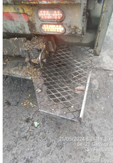
Foto 23. Vehículo Compactador con placa UFG690 con estribos rotos y deteriorados
