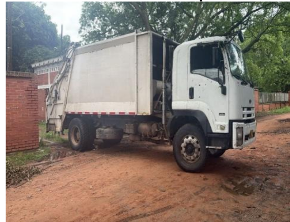
Foto 49. Vista trasera – Luz estroboscópica encima de la tolva, manijas y estribos
