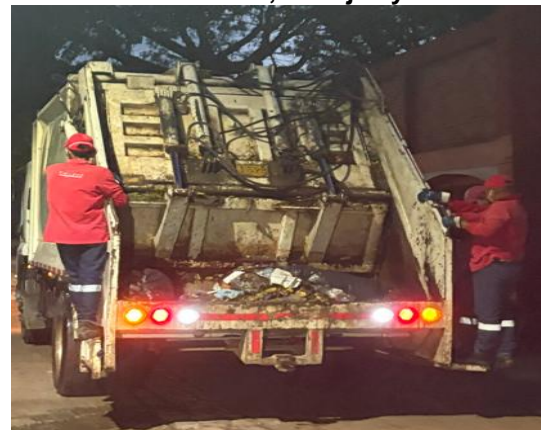
Foto 49. Vista trasera – Luz estroboscópica encima de la tolva, manijas y estribos
