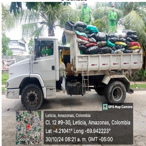
Foto 9. Volqueta NON-3786 AM-EIRUNEPE (Brasil), sin elementos complementarios, sin equipo de compactación, sin estribos, manijas o balizas
