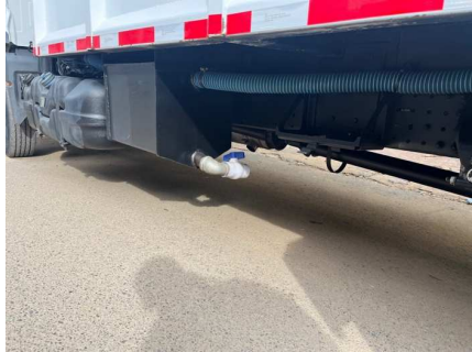
Imagen 34 Tanque almacenamiento y descargue de lixiviados
