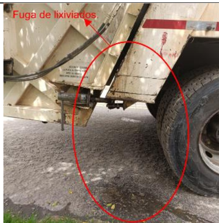
Vehículo con fuga de lixiviados..
